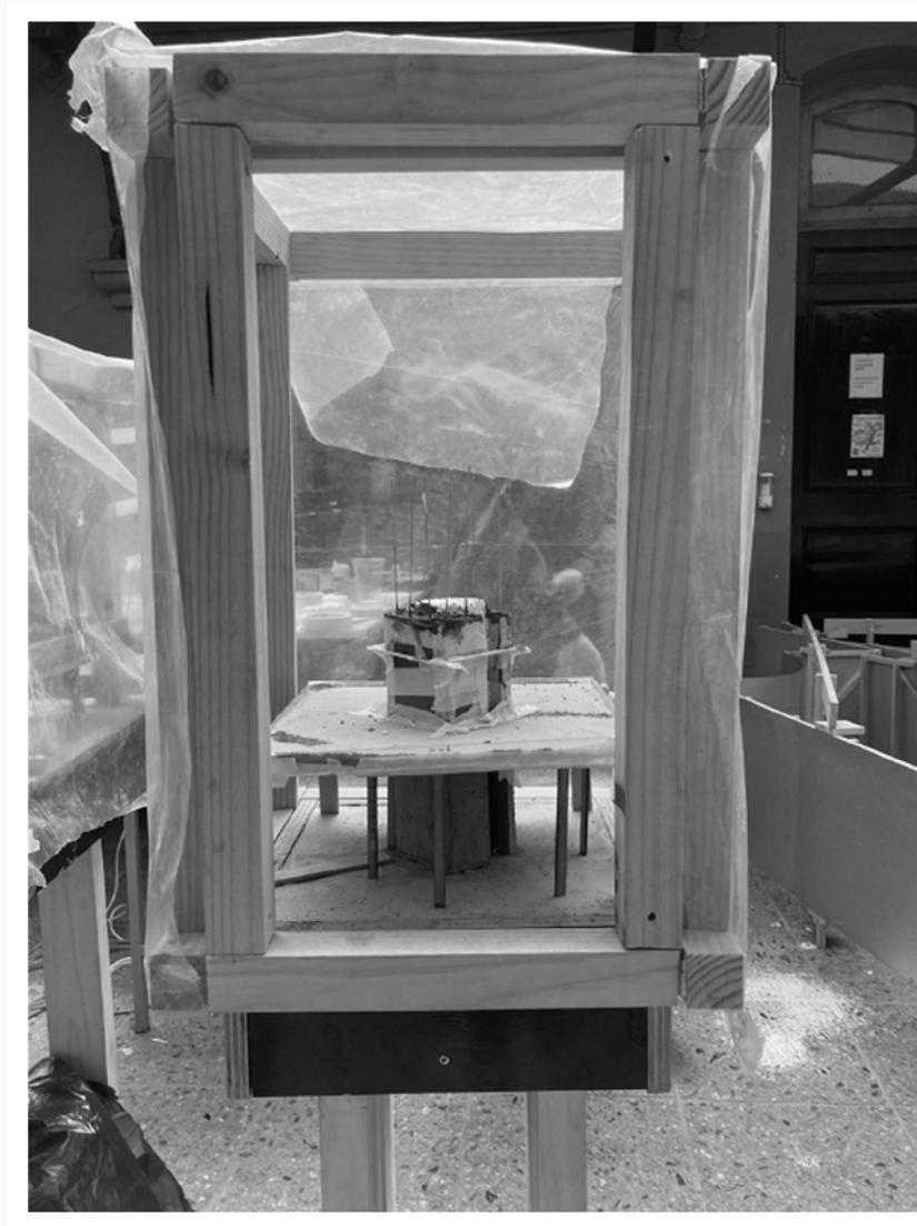
**IMAGEN 4** Maqueta contenida en cámara de humedad para lograr el curado de las piezas. Fuente: Equipo de investigación Esqueletos Modernos
