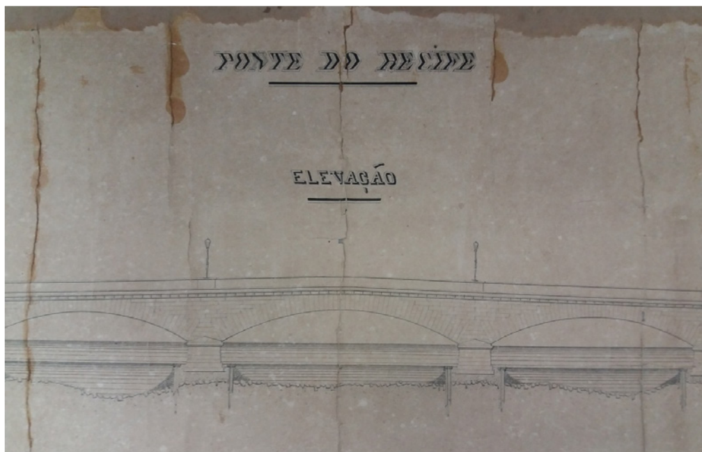
FIGURA 10 Proyecto del puente de Recife en hormigón armado, realizado por la Dirección de Obras Públicas. Fuente: Acervo do Arquivo Público do Estado de Pernambuco Jordão Emereciano; Série Obras Públicas.
