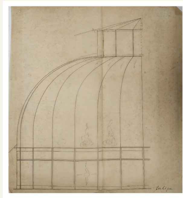
FIGURA 8 Estructura del lucernario sobre la escalera en la casa de Rosales 200 (Archivo Manuel Cortina García, carpeta 71, expediente 1).
