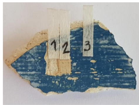
FIGURA 18 Trabajos de limpieza y descubrimiento de pigmentos originales de la cúpula. Azul y dorado son los tonos principales que se repiten en diferentes elementos ornamentales, mobiliario, cortinas, etc. En la imagen se puede ver el detalle de casetón que revela la existencia de policromías originales en estos tonos. FIGURA 19 Detalle de cinta dorada (policromía) en bordes de cenefa interior de cúpula y casetón con borde dorado con trampa. Fuente: Archivo de la obra
