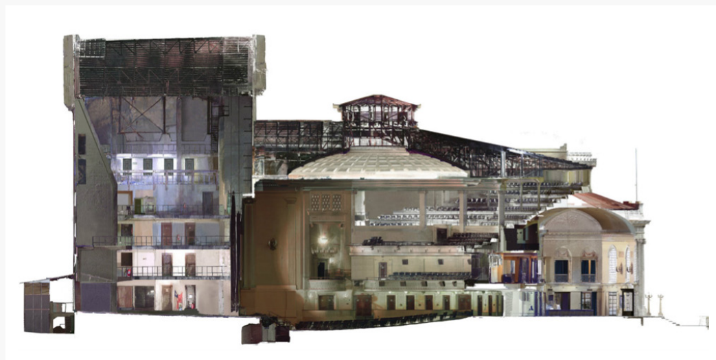
FIGURA 5 Levantamiento crítico, corte interior con tecnología láser. Fuente: Studio Re consultores
